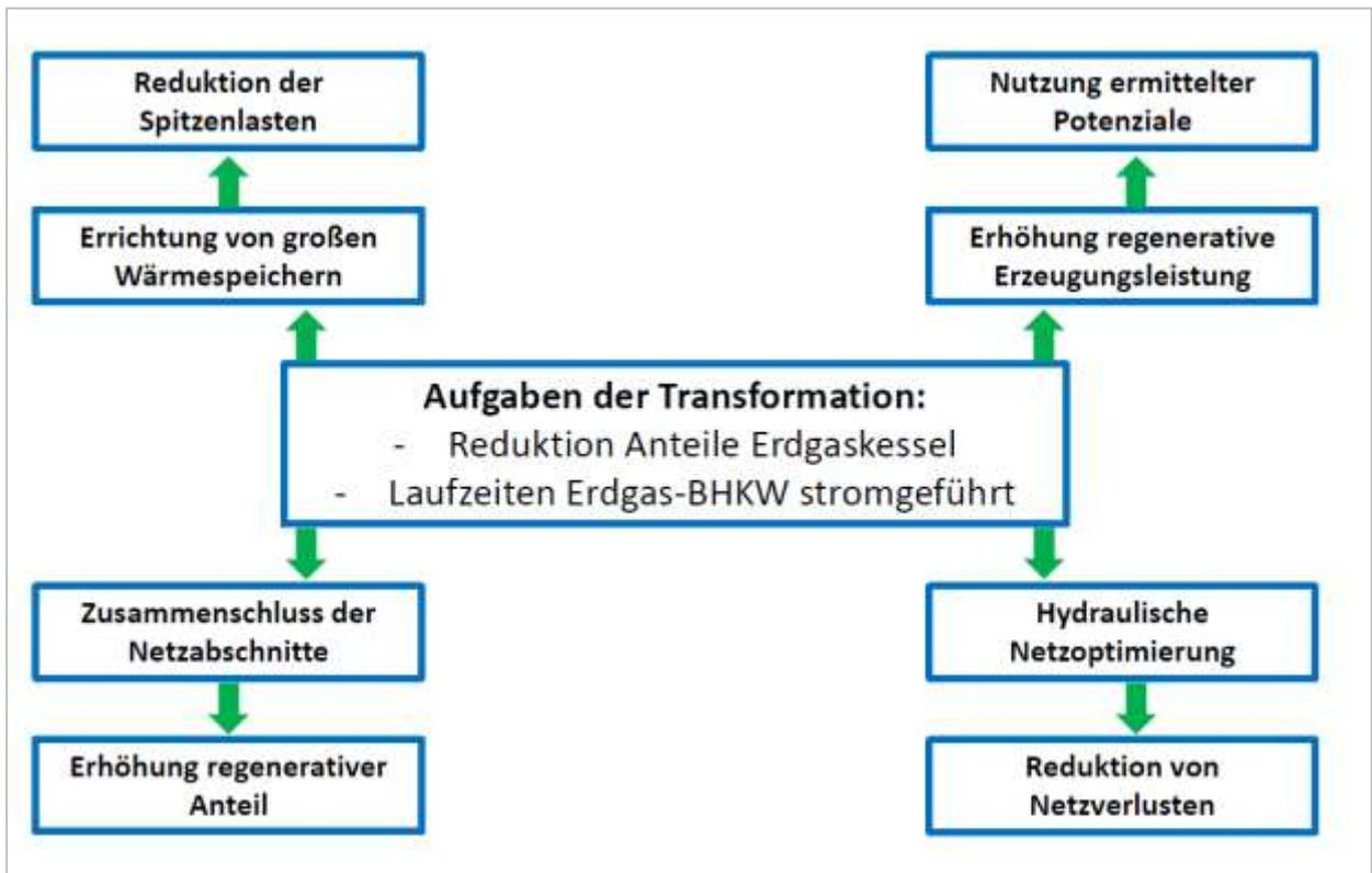
Abb. 11: Aufgaben der Transformation bestehender Heizzentralen und Wärmenetze
