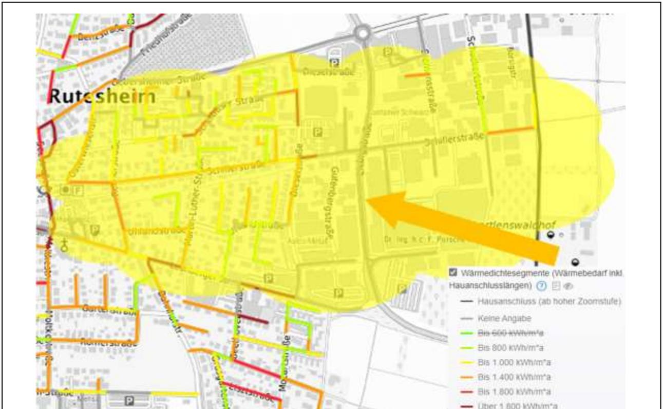
Abb. 47: Wärmedichten mögliches Quartier Rutesheim-Ost mit Biogasanlage
