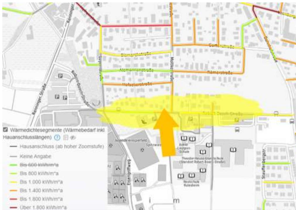
**Abb. 48: Wärmedichten für mögliche Erweiterung Robert-Bosch-Straße**
